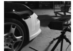
Scan des Handmusters mit OPTIX 400 Scanner von 3D Scanworks
