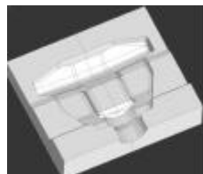
Schmiedeteil: Laserscanner- Digitalisierung / Reverse Engineering
