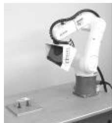
3D ScanInspector / QS Prüfroboter Soll-/Istvergleich. VDA-Prüfbericht
