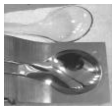
Werkzeug Kunststoffartikel: 3D Digitalisierung / CAD Redesign / CAM Rapid Tooling
